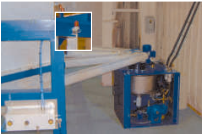
▲ Trocken-Flüssig Dosieranlage TFW 90 für 4 Farben.
