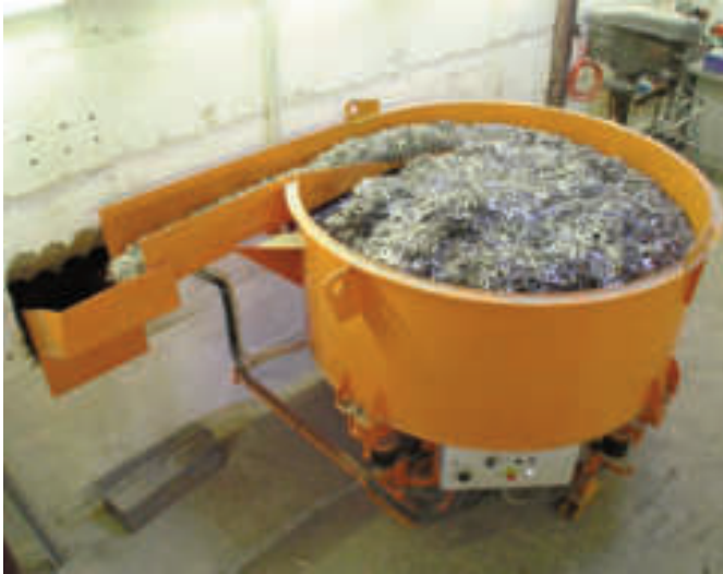
▲ Dosieranlage MD 400 für Stahlfasern, Kapazität 40-150 kg/min, Füllmenge 600-1200 kg
