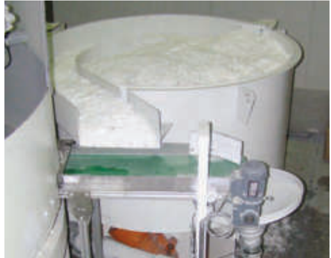
▲ Dosieranlage MD 500 SX für PP-Fasern, Kapazität 3-15 kg/min, Füllmenge bis 400 kg
