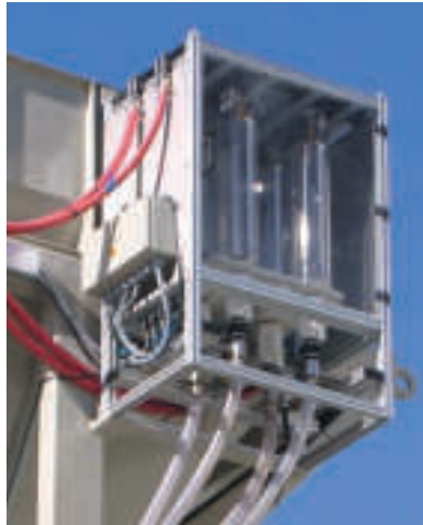
AC 5/5/15/15 Waage in Schutzschrank, Entleerung durch Schwerkraft für 8 Zusatzmittel in 4 Zylinder
