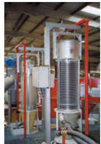
▲ Filterzyklon CF 40-S mit elektronischer Wägezelle und leicht zu reinigendem Filterelement
