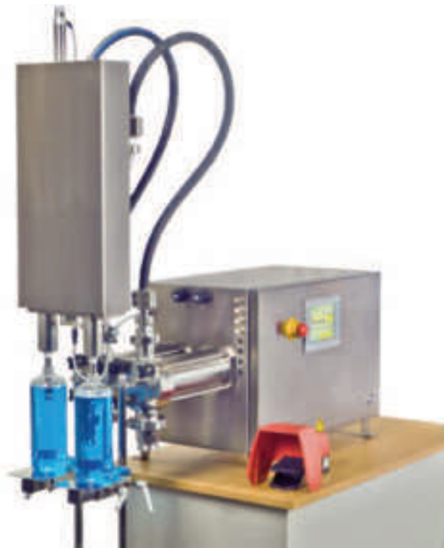
▲ Touch Fill mit Doppelkolben und Unterspiegelabfüllung mit Nachtropfverhinderer
