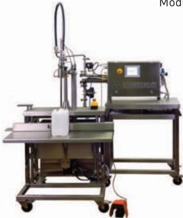
▲ Touchline im halbautomatischen Betrieb mit Unterspiegelabfüllung und Abfülltisch
