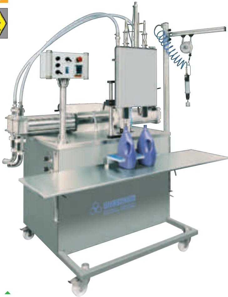
PA 3500-2-UA Doppelkolbenausführung mit Unterspiegelabfüllung, SPH-3-DE Verschrauber
