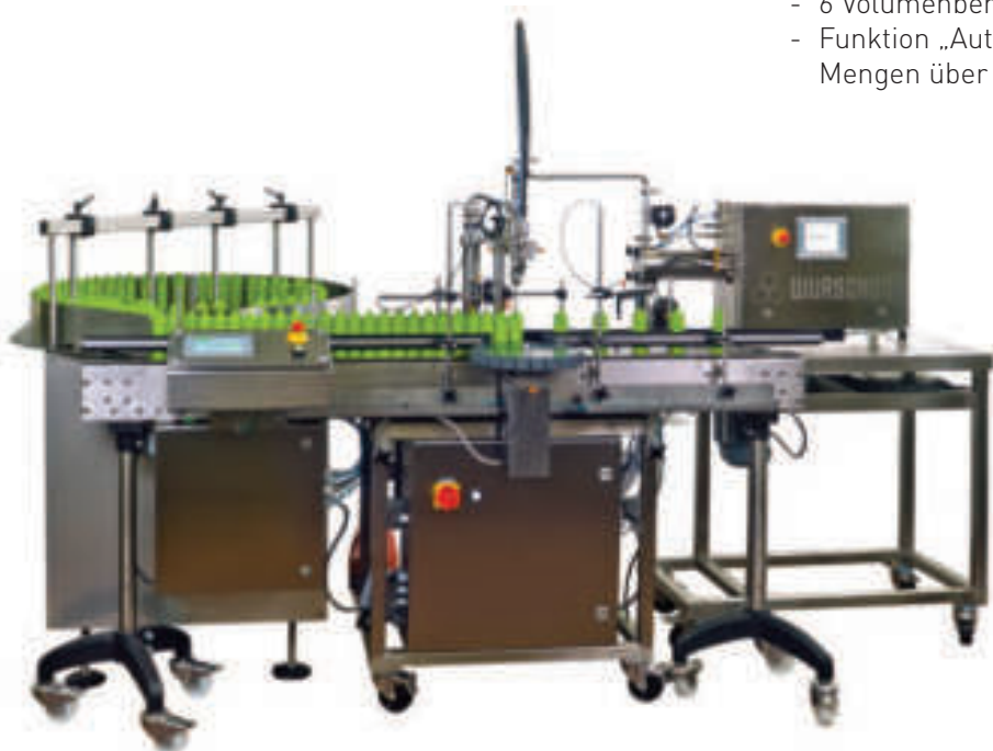
▲ Touchline im automatischen Betrieb mit Aufgabedrehteller und Transportband
