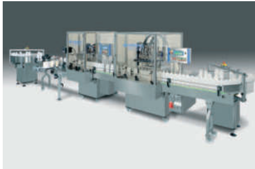
▲ AFS 1000-4 / AV-200 Abfüll- und Verschließmaschine für flüssige und pastöse Medien.
